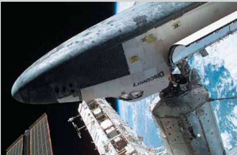
Die Discovery hat am PMA 2-Adapter festgemacht. Daran anschließend sind das LAB "Destiny", das angekoppelte MPLM (untere rechte Ecke) und links vom LAB die Trägerstruktur P1 zu sehen. Links unten ragt eine Solarzellenbahn des P6 ins Bild.
