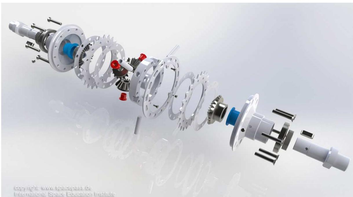
Explosionszeichnung des Differentialgetriebes der 2. Generation (2010-2012)
