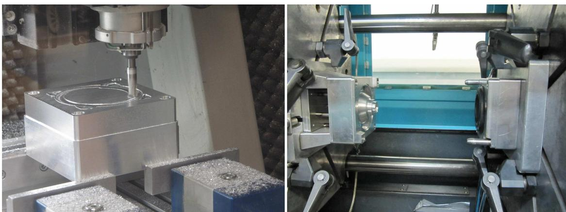
Herstellung der Spritzgusswerkzeuge und Pressen des ersten Getriebedeckels
