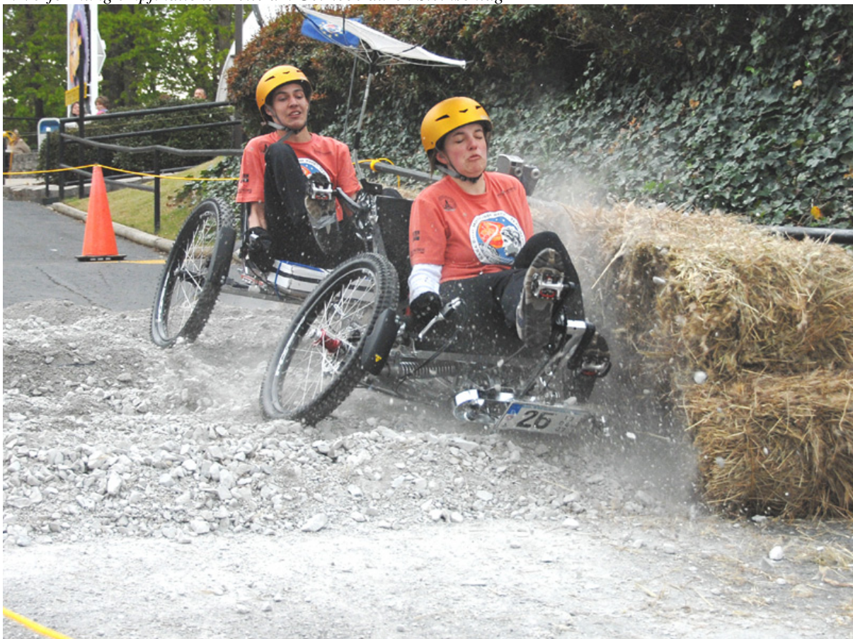
3. Eintauchen der zu weichen Federn (das Fahrzeug befindet sich trotzdem auf hoher Fahrt)
