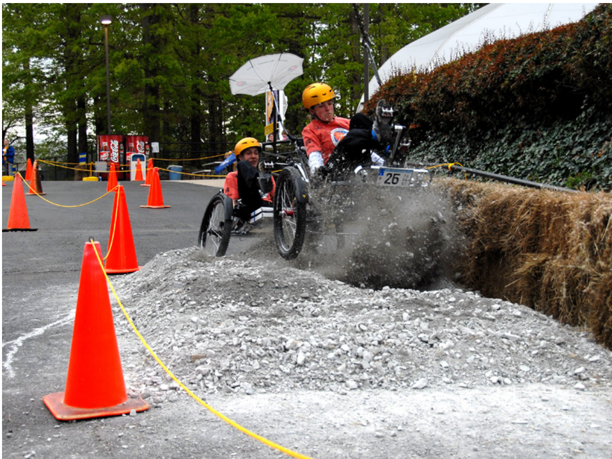
1. Touchdown am Hindernis durch zu spätes Bremsen und weiche Federn
