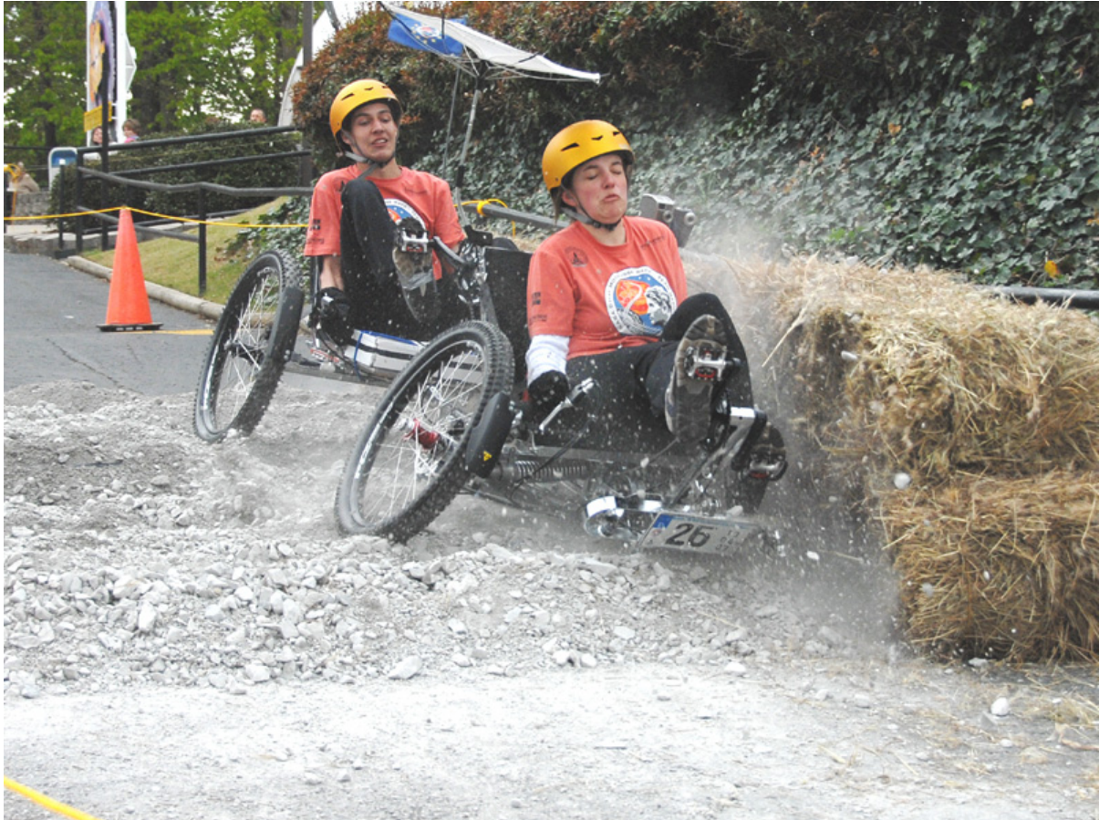
3. Eintauchen der zu weichen Federn (das Fahrzeug befindet sich trotzdem auf hoher Fahrt ohne Zerstörung!)
