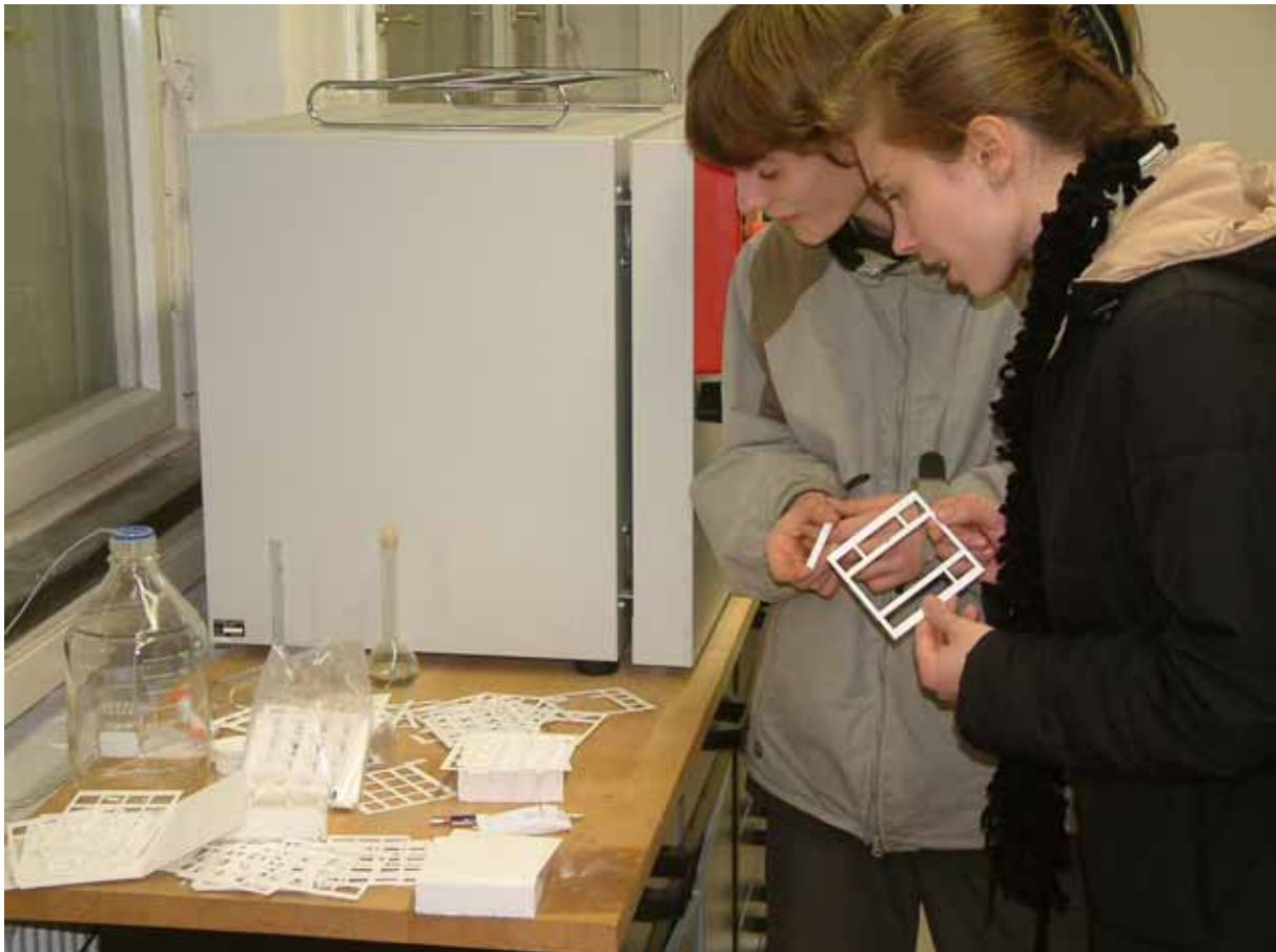
Abstandhalter aus Aluminiumoxyd für das Sintern von Keramikelementen für Sauerstoffsensoren sind sehr kalt
